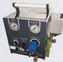
Trockeneisstrahlgeräte für mobile und umweltfreundliche Oberflächenbearbeitung
