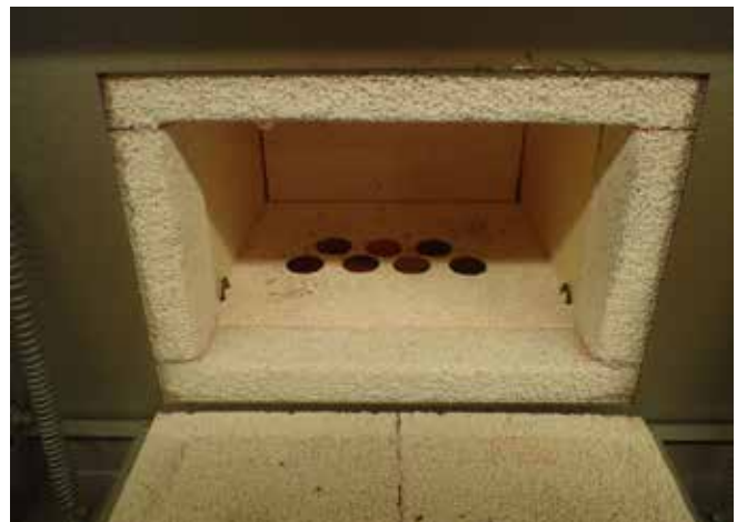
Abbildung 1: Beschichtete Probekörper während des Anlassprozesses
