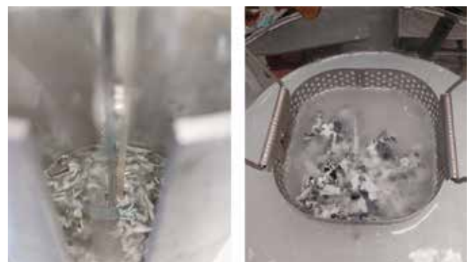
Abbildung 2: Zerkleinerte und lackierte Kunststoff-Flakes in BBL im Laborreaktor (DTNW)
