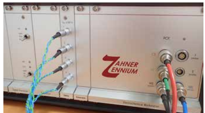
Abbildung 2: EIS-Steuerung mit PAD4-Modul
