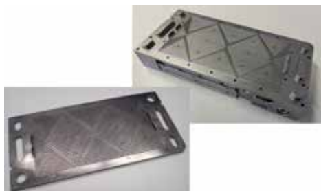
Abbildung 1: Werkzeugeinsatz (oben), spritzgegossene Bipolarplatte (unten)
