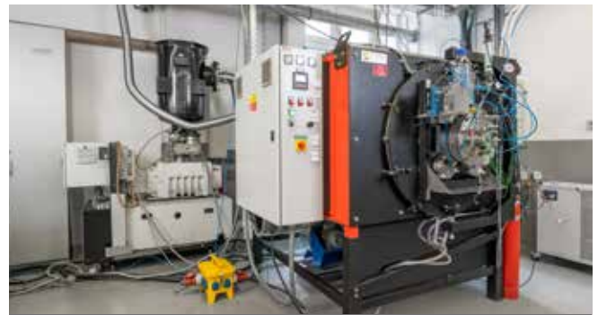
Abbildung 4: Reaktor der CVD 3 mit angeschlossenem Pumpenstand
