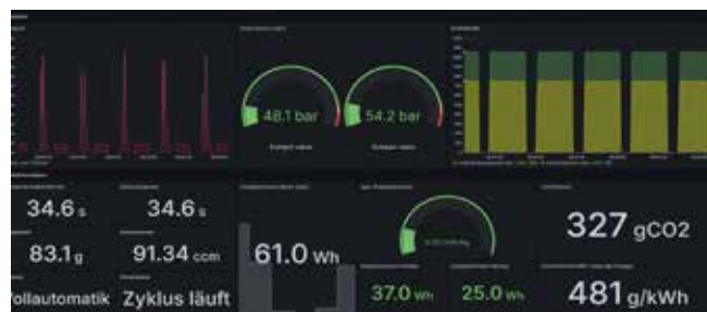
Abbildung 1: Live-Visualisierung einer vernetzten Spritzgießmaschine
