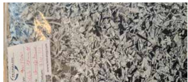
Abbildung 1: zerkleinerte und lackierte PC-ABS Kunststoff-Flakes (TETRALOG upcycling GmbH &amp; Co. KG)
