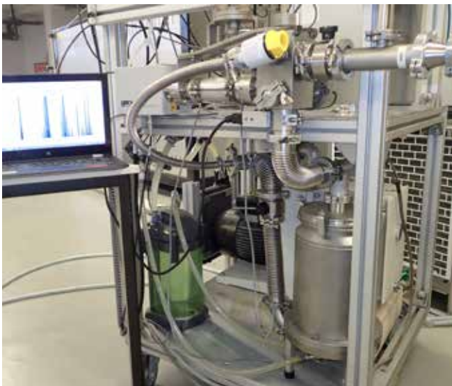
Abbildung 1: RGA mobile Messstation
