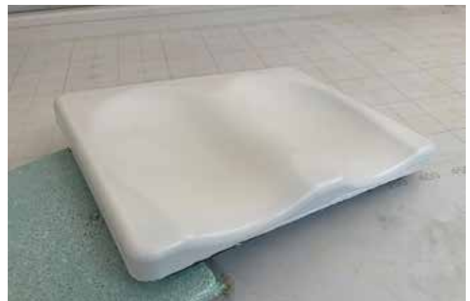
Abbildung 1: Mit rezykliertem EPP hintereschäumte Lackierung, Sitzauflage
